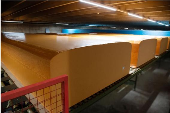
Produktion von Schaumstoffblöcken mit 80 Prozent Recyclinganteil
